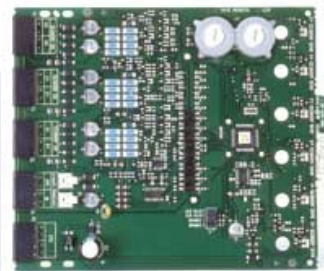
Módulo de zona analógico para sensores convencionales. Mód.MI-CZ6 y caja opcional de superficie Mód.SMBW-V0
